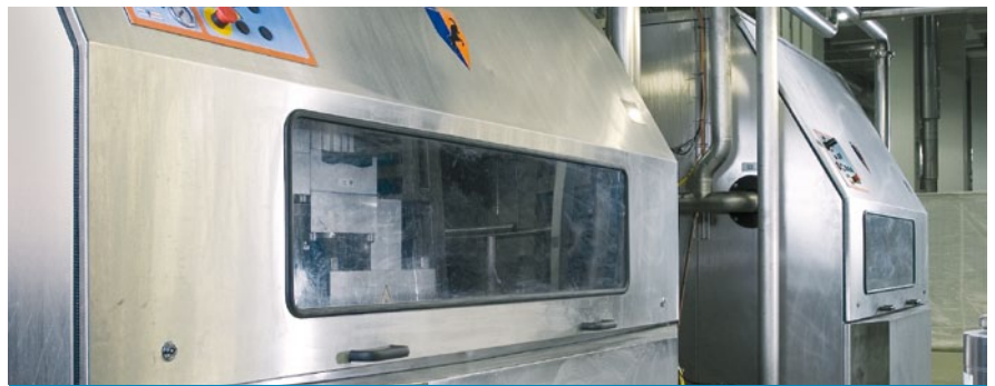
Homogenisatoren mit einer Leistung von 50.000 l/h, 180 bar
