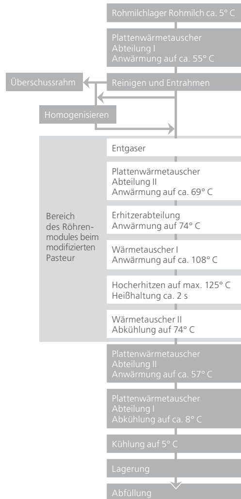
Blockdiagramm zum Prozessablauf des modifizierten Pasteurs
